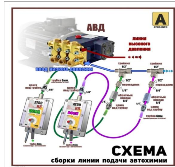
Рис. 1.1 Схема подключения дозаторов без КДП (все переходники и клапана можно найти самостоятельно)
