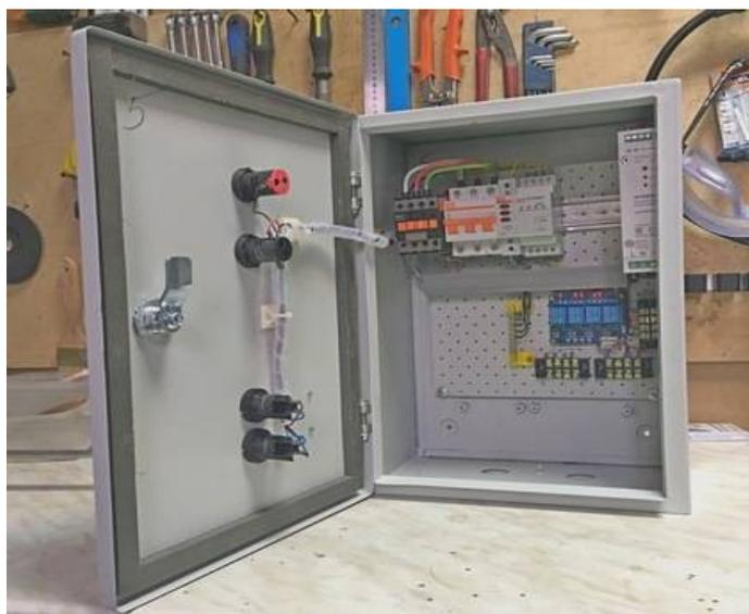
На фото Монтажный силовой блок с управлением цифровыми дозаторами
