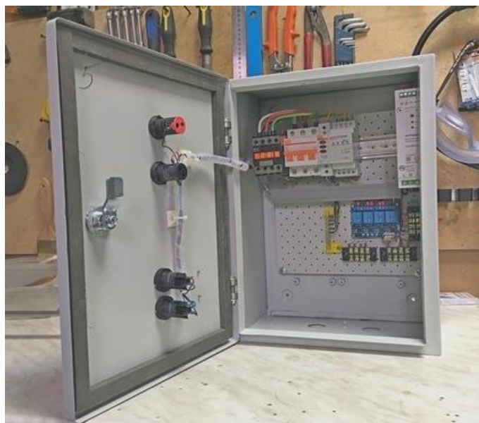
На фото Монтажный силовой блок с управлением цифровыми дозаторами
